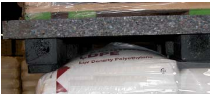
Figuur 16: Test - conceptontwerp M3 (opbollende zakken onder gestapelde pallet)
